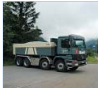
Poids lourd de référence pour calibration du système OSMOS-WIMS installé
