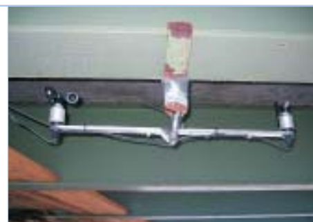
Mesure de la vitesse et de la direction du vent, un des paramètres de suivi complémentaires pour affiner le diagnostic
