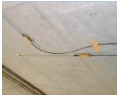
Combinaison de cordes optiques et d'extensomètres optiques en sous-face de tablier
