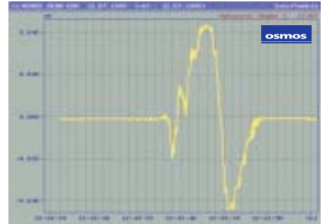
Déformation caractéristique au passage d'un véhicule d'essai lors de l'installation. Le retour parfaitement élastique va confirmer la disponibilité sécuritaire du pont pendant six ans
