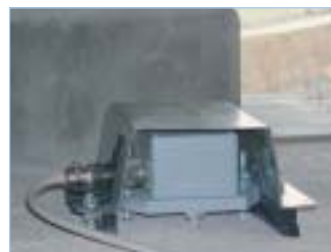
Accéléromètre protégé des chocs dus à des projections de matériaux
