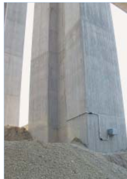
Accéléromètre protégé des chocs dus à des projections de matériaux
