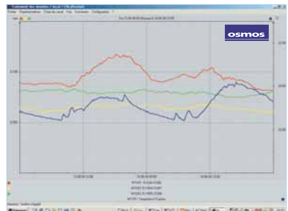
Mesures journalières combinant déformation et inclinaison du bâtiment
