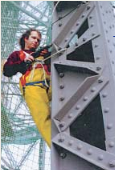
Seule la Corde Optique permet d'obtenir la déformation moyenne d'une pièce hétérogène
