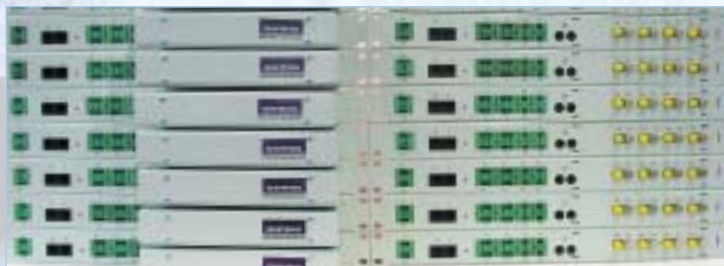
La station de monitoring accueille par module 4 capteurs OSMOS et 8 capteurs non-OSMOS. Elle se configure via Windows Explorer
