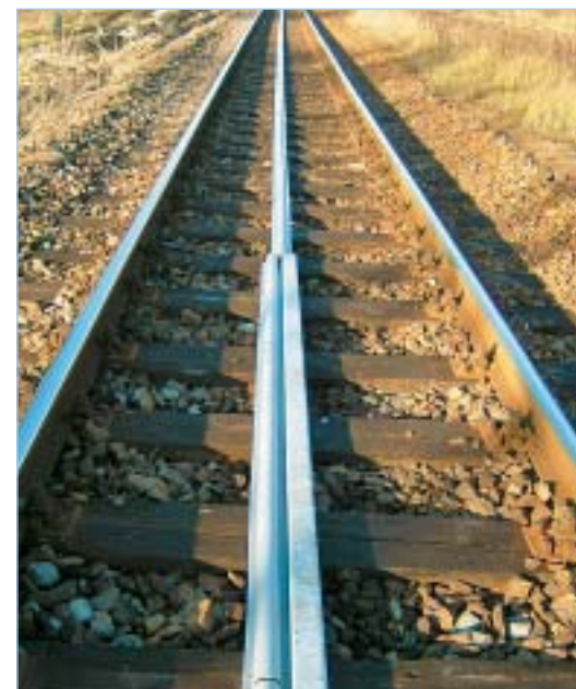
Détecteur d'affaissement OSMOS sur 800 m Vue d'ensemble au lancement de la surveillance
